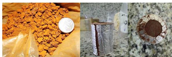
Figura 3 – Exemplo de preparação de plugue de material friável.
