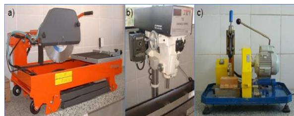
Figura 2 - (a) serra; (b) plugadeira de bancada; (c) retificadora de plugues.
