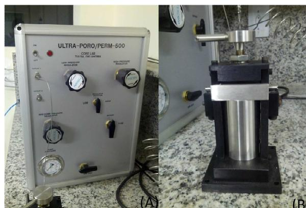
Figura 4 - (a) Permoporosímetro a gás; (b) *matrix cup*.
